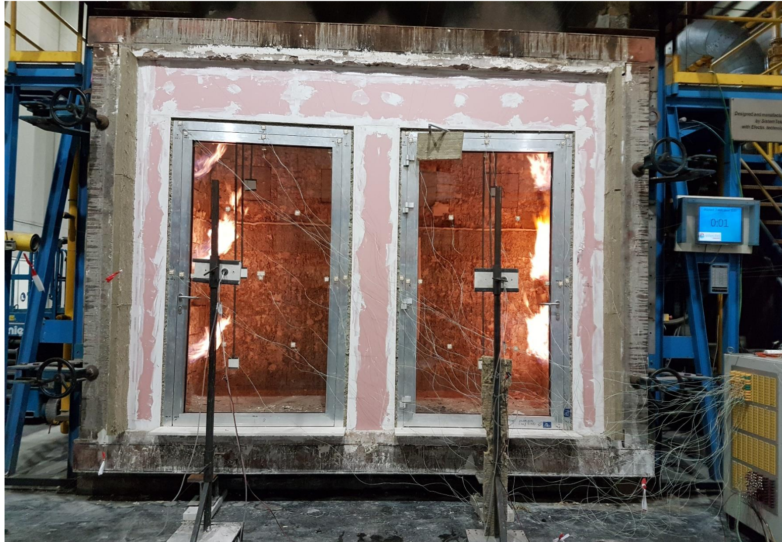
System przeciwpożarowy FR90 Laboratorium EFFECTIS, Holandia EI 60, drzwi jednoskrzydłowe EI 30
