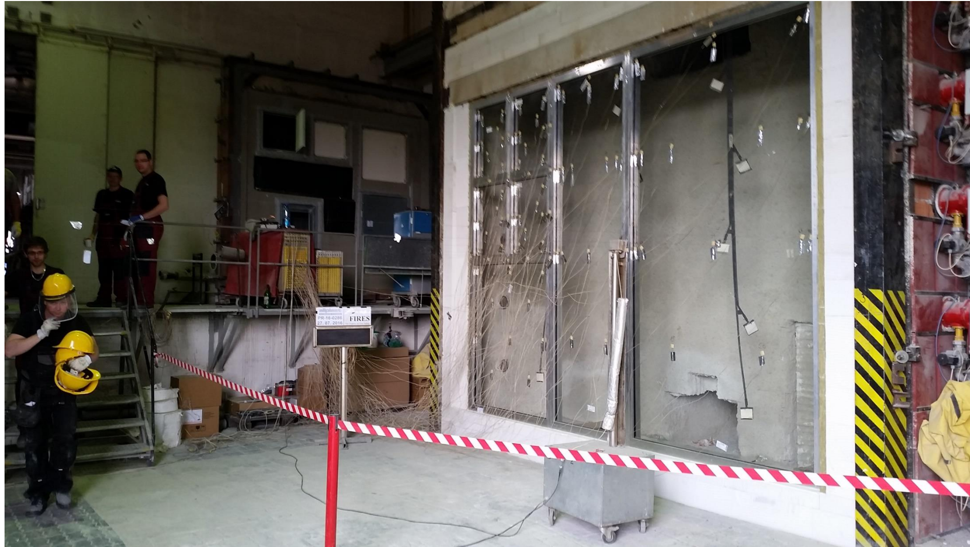
System przeciwpożarowy FR90 FIRES EI 60, przeszklenie stałe
