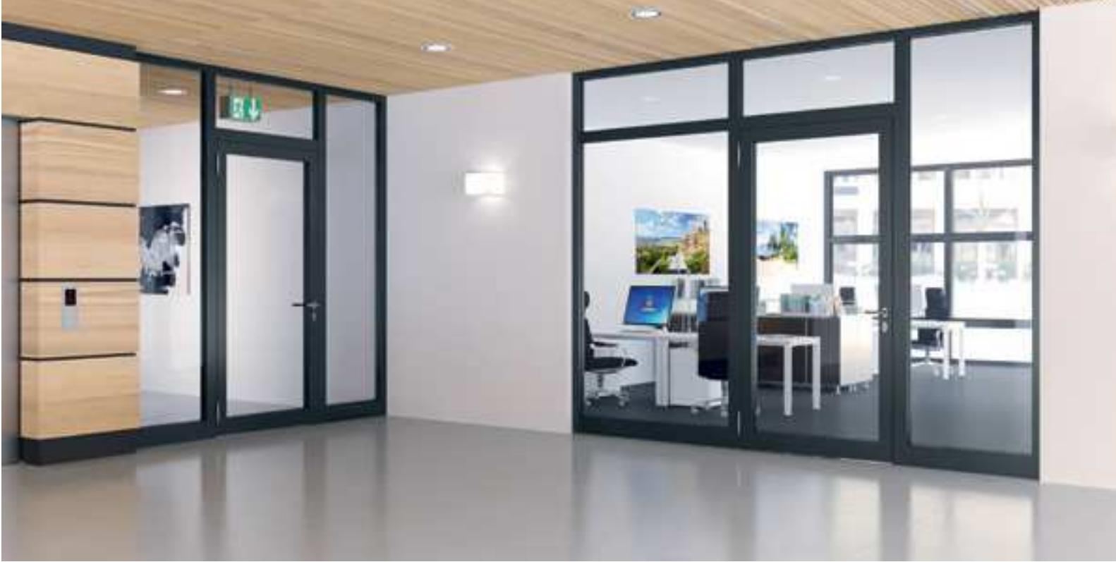
Protipožární sklo ANTIFIRE® 22 – EI 30 je produkt z protipožárně certifikovaného bezpečnostního skla. Požární a tepelná bariéra je přitom vytvářena přes vnitřní vrstvu gelu, která se
